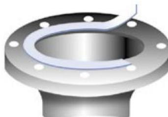
**ACHTUNG:** Es darf kein zusätzliches Anti-Klebespray oder Flüssigklebstoff auf die Flanschoberflächen aufgebracht werden. Bei Kälte sollte das Dichtungsband vor der Montage leicht erwärmt werden.
